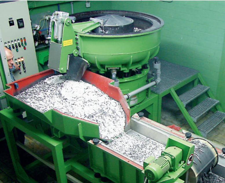
Zur mechanischen Oberflächenbehandlung (Entgraten, Polieren) oder auch als Vorbereitung für eine galvanische Oberflächenbehandlung metallischer Kleinteile setzen wir das Gleitschleifen sowohl im Trommelverfahren als auch im Vibrations- und Fliehkraftverfahren ein.
